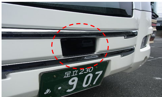
【歩行者検知機能付衝突回避支援装置搭載車両（センサー）】
