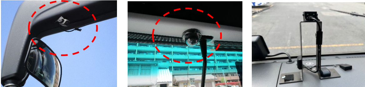
【バス前方・後方・側面・車内の映像を確認するドライブレコーダーカメラ】
